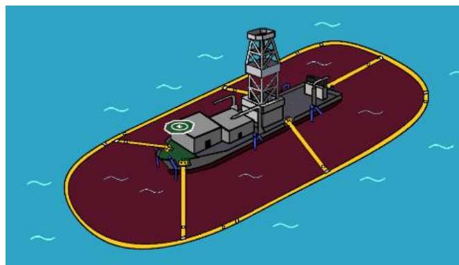
Рисунки 10 и 11 – Иллюстрация аксонометрического вида на нефтяной танкер и буровое судно с расправленным устройством, при полной заполненности нефтью окольцованного пространства вокруг нефтяного танкера в рамках проведения всех этапов алгоритма действий
