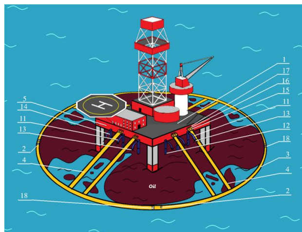
Рисунки 5 и 6 – Схематичная иллюстрация аксонометрического вида на нефтяную платформу с размещенным устройством до и после возникновения разлива нефти
