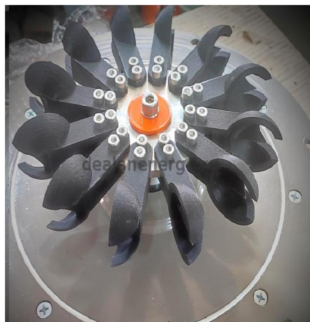
Рисунок 2 – Ротор микро-ГЭС GS Hydro K-2
