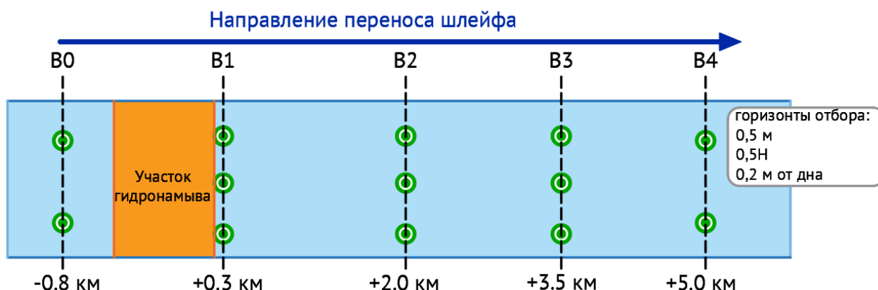
Рисунок 1 – Схема пунктов контроля и горизонтов отбора проб при гидронамыве
