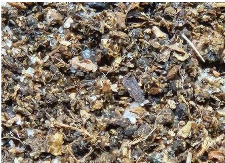
Рис. Внешний вид шлама из суспензии при увеличении 10^{\times}
