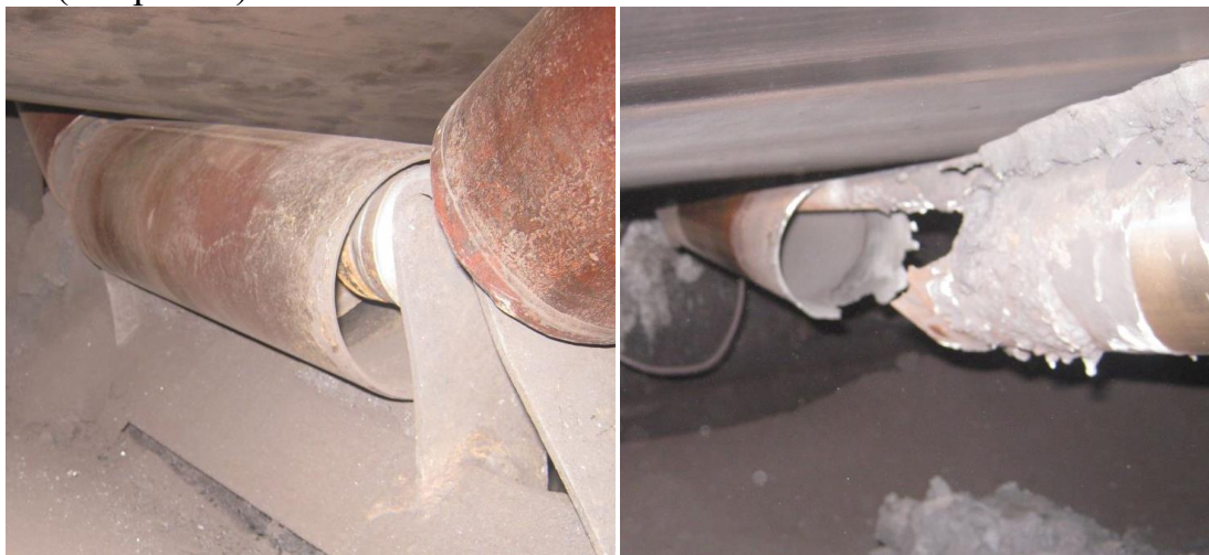
Рисунок 2 – Фото износа роlikов
