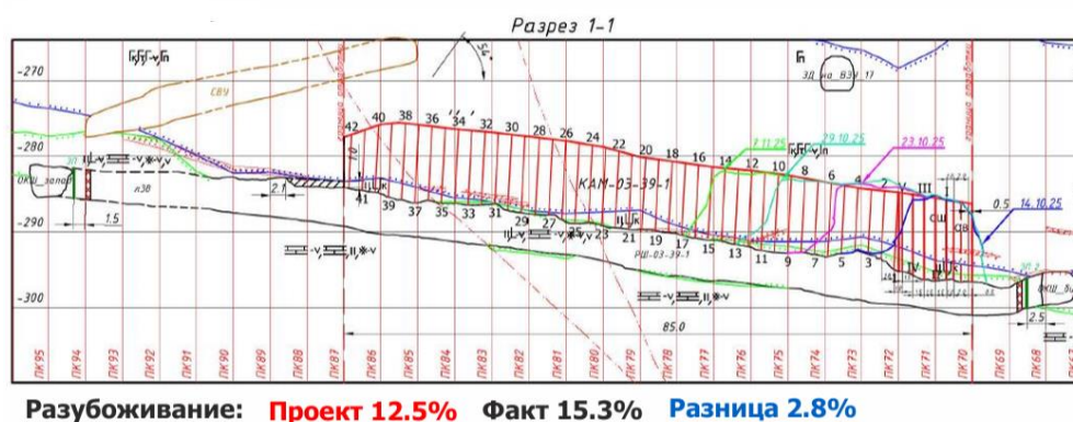
Рис.3. Результаты бурения в автоматическом режиме на руднике «Комсомольский», КАМ-03-39-1
