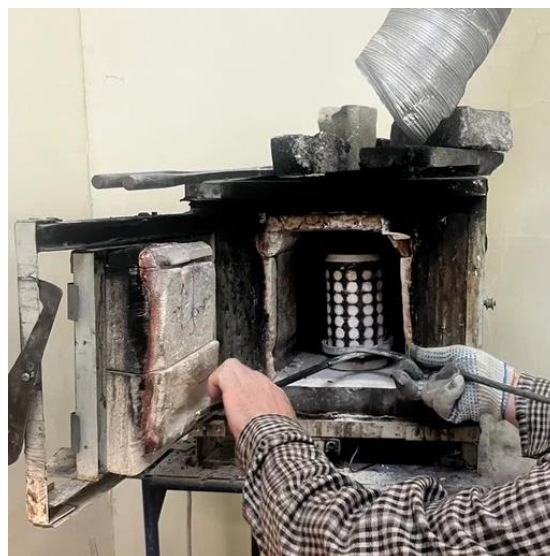
Рис. 3. Прокаливание гипсовой формы
