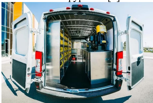
Рис.2. Мобильная установка для ремонта, и производства гидравлических рукавов BASIN UPFITTING и Hydroscand
