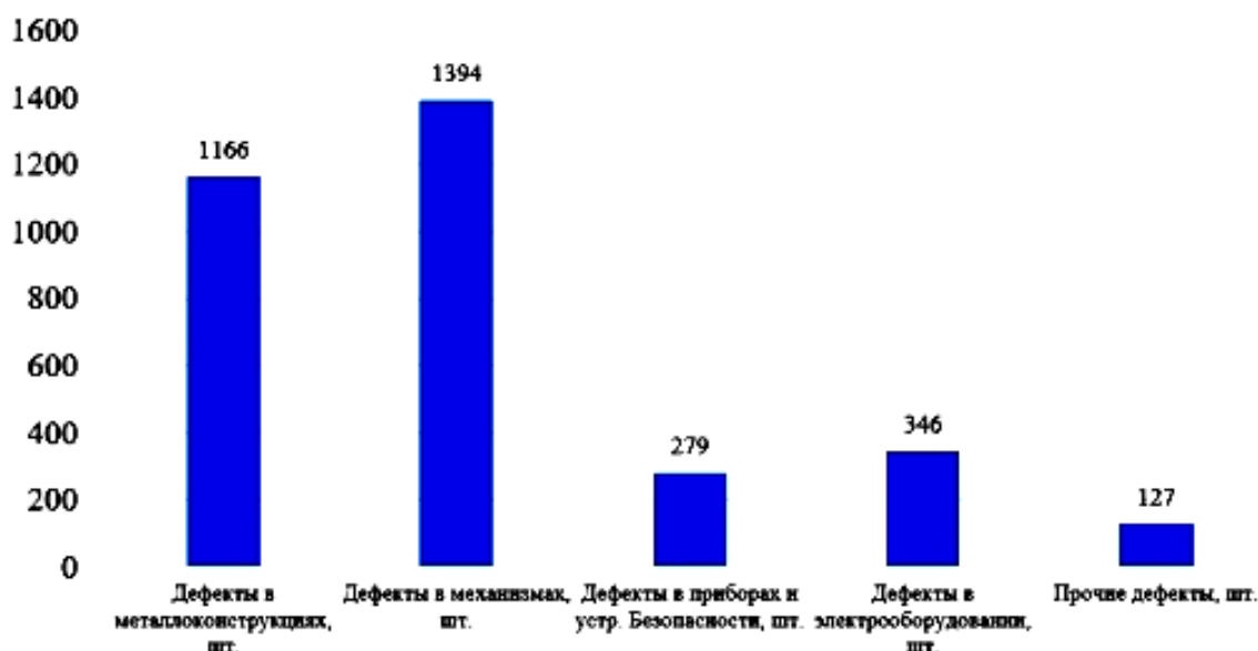
Рис. Выборка данных по дефектам кранов и перегружателей за 2003–2024 гг., данные представлены ООО «СпецРемНаладка»
