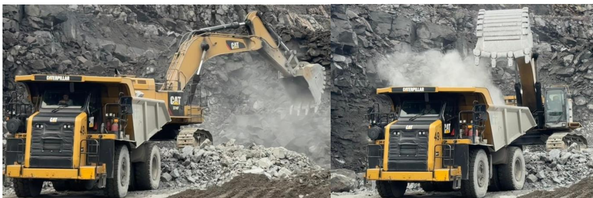
Рис. Пылеобразование при погрузке взорванной гранитной массы
