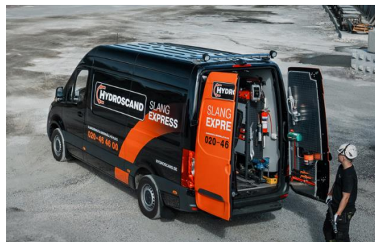
Рис.2. Мобильная установка для ремонта, и производства гидравлических рукавов BASIN UPFITTING и Hydroscand
