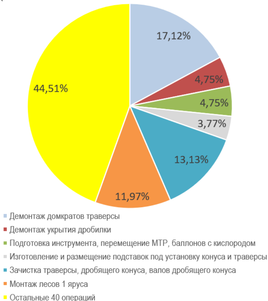
Рис.2. Основные факторы, влияющие на эффективность проведения ремонта дробилки ККД-1500
