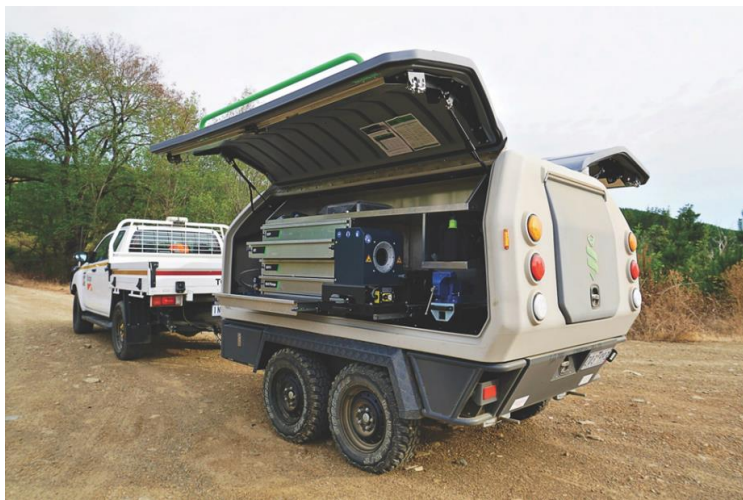
Рис.1. Мобильная установка для ремонта и обслуживания гидравлического оборудования ВОАрод
