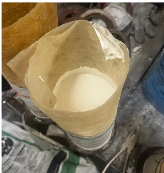
Рис. 2. Опока с суспензией
