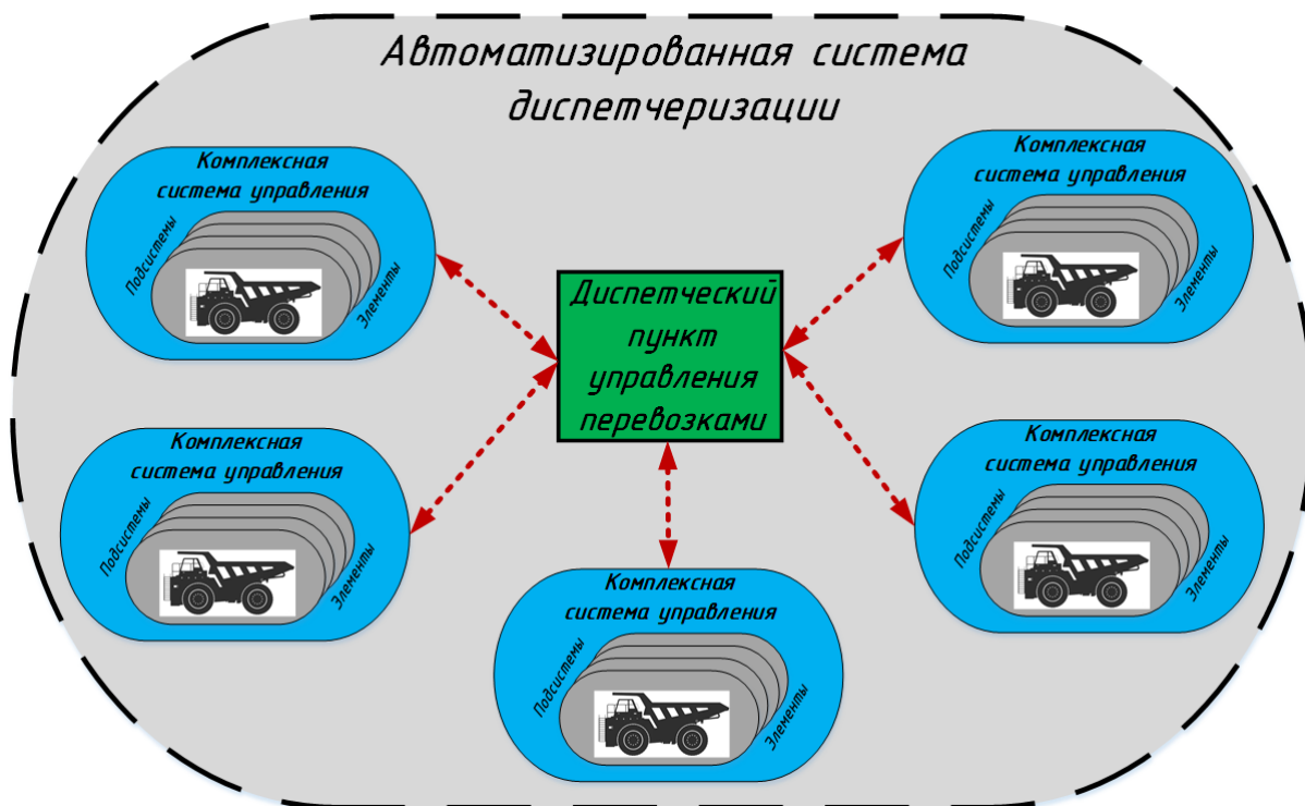
Рис. 1. Принципиальная схема управления парком роботизированных самосвалов на грузовых перевозках
