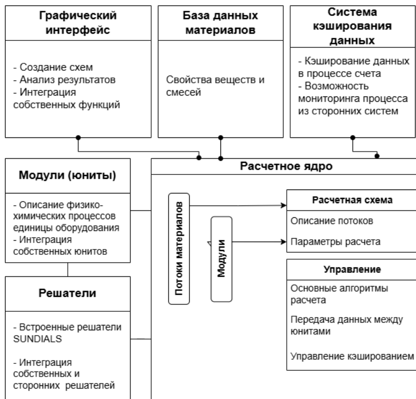
Рис. 1. Архитектура программного комплекса SolidSim
