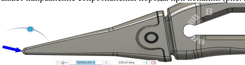
Рисунок 2 – Схема задания нагрузки и граничных условий
