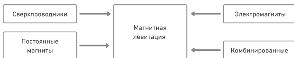
Рис. 1. Способы создания магнитной левитации
