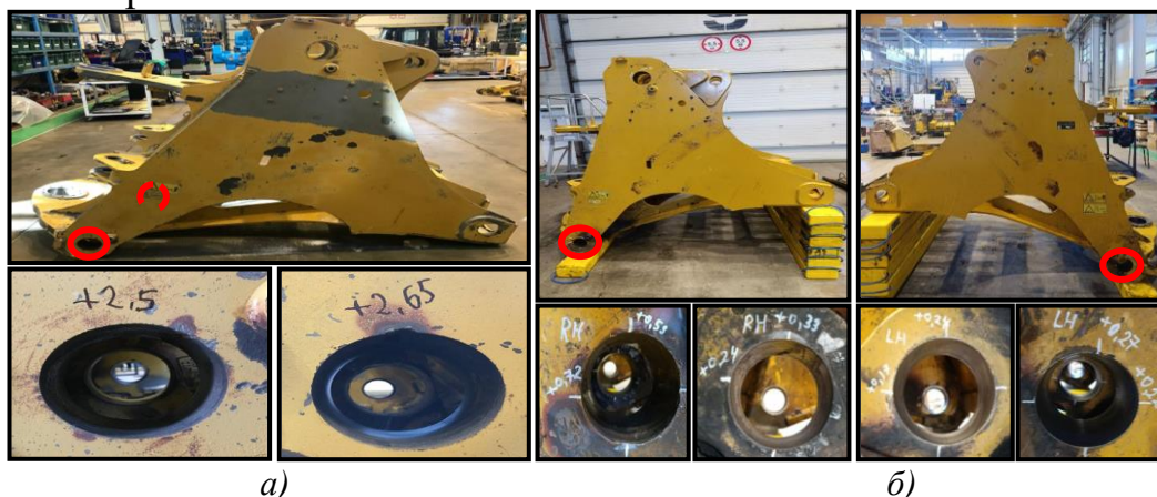
Рис. 1 Износ внутренних диаметров проушин крепления гидроцилиндров подъема стрелы рамы № 1 и № 2
