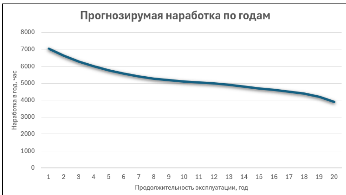
Рисунок 2. График прогнозируемой наработки по годам, по полученной функции.
