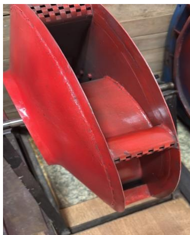
Рис. 2. Вид на лопатку рабочего колеса газоотсасывающего вентилятора Ц125–18П Аэродинамическая характеристика вентилятора
