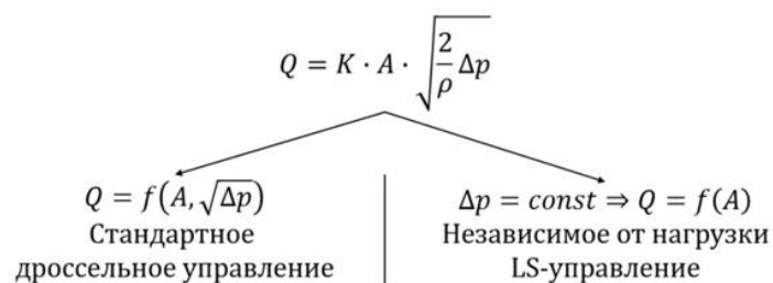
Рис. 1. Способы управления гидросистемой
