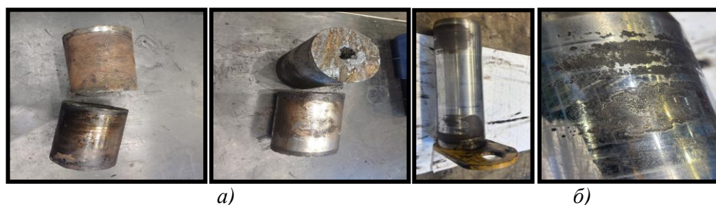
Рис. 2 Пальцы крепления гидроцилиндров подъема стрелы к раме №1 и №2
