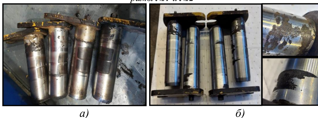
Рис. 5 Пальцы крепления рулевых цилиндров к раме №1 и №2
