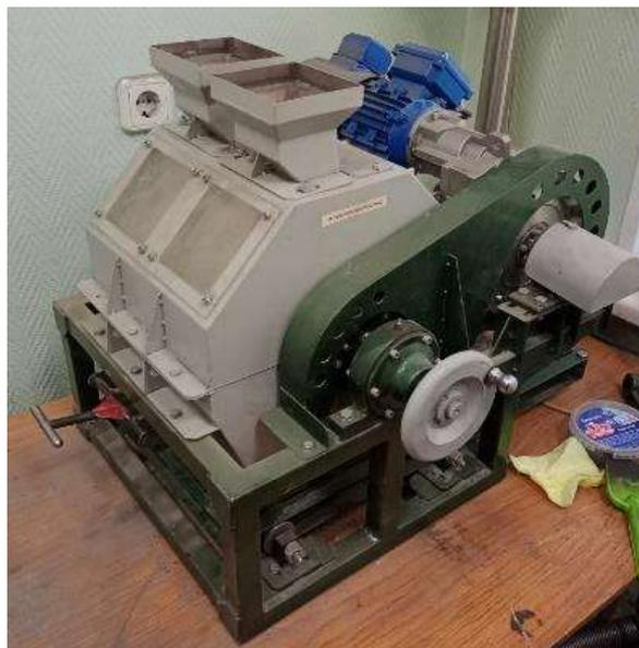
**Рисунок 2 – Барабанный сухой магнитный сепаратор с полем напряженностью 1100Э и 2000Э**
