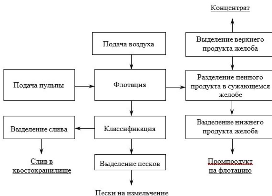
**Рисунок 1 – Схема флотоклассификации с разделением пенного продукта в сужающихся желобах**
