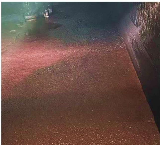
**Рисунок 2 – Внешний вид цементного осадка в баке сборном на опытном участке цементационного извлечения меди из подотвальной воды**
