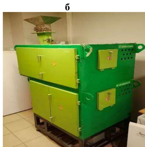
**Рисунок 3 – Лабораторный валковый сухой магнитный сепаратор (а), для сепарации класса крупности -3+1 мм в поле напряженностью до 14000 Э, и ленточный сухой магнитный сепаратор(б) для сепарации материала класса крупности -6+3 мм в поле напряженностью 10000 Э**
