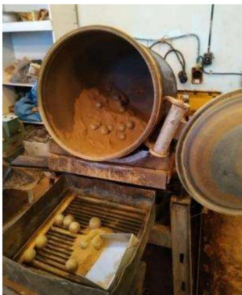
**Рисунок 2 – Лабораторная шаровая мельница МШЛ-120**
