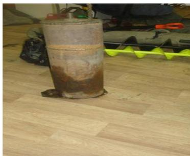
Рисунок 2 - Пробоотборник для отбора проб донных отложений
