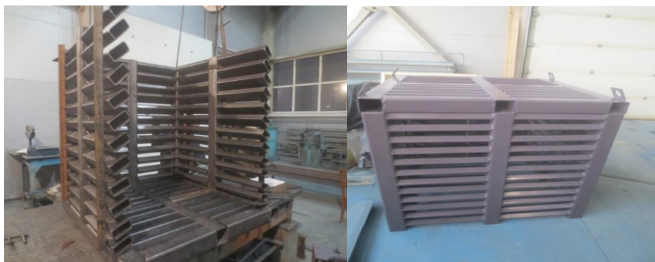
Рис. 2. Локализатор в процессе изготовления
