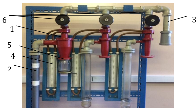
Рис. 1. Пневматический парусно-порционный классификатор
