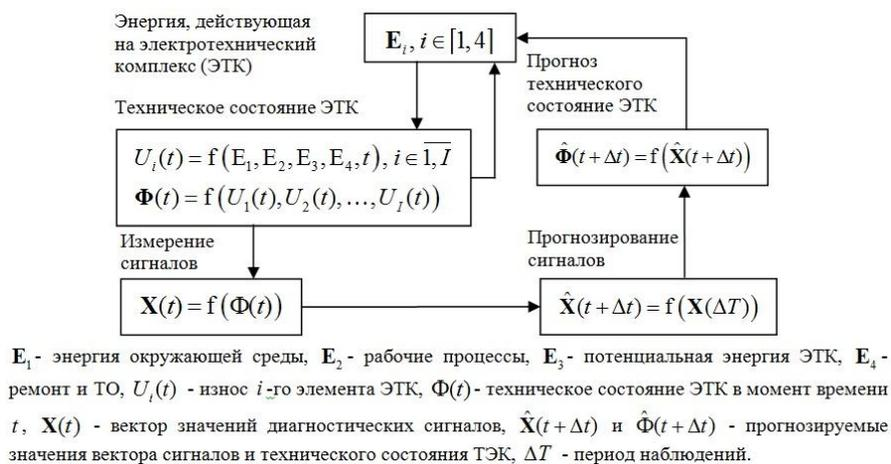
Рисунок 1 – Общая модель процесса функционирования электротехнического комплекса
