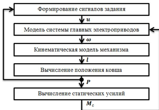
сигналов задания  $u$ . Система электропривода обрабатывает возмущения, заданные вектором  $M_c$  и возвращает вектор угловых скоростей  $\omega$ .
