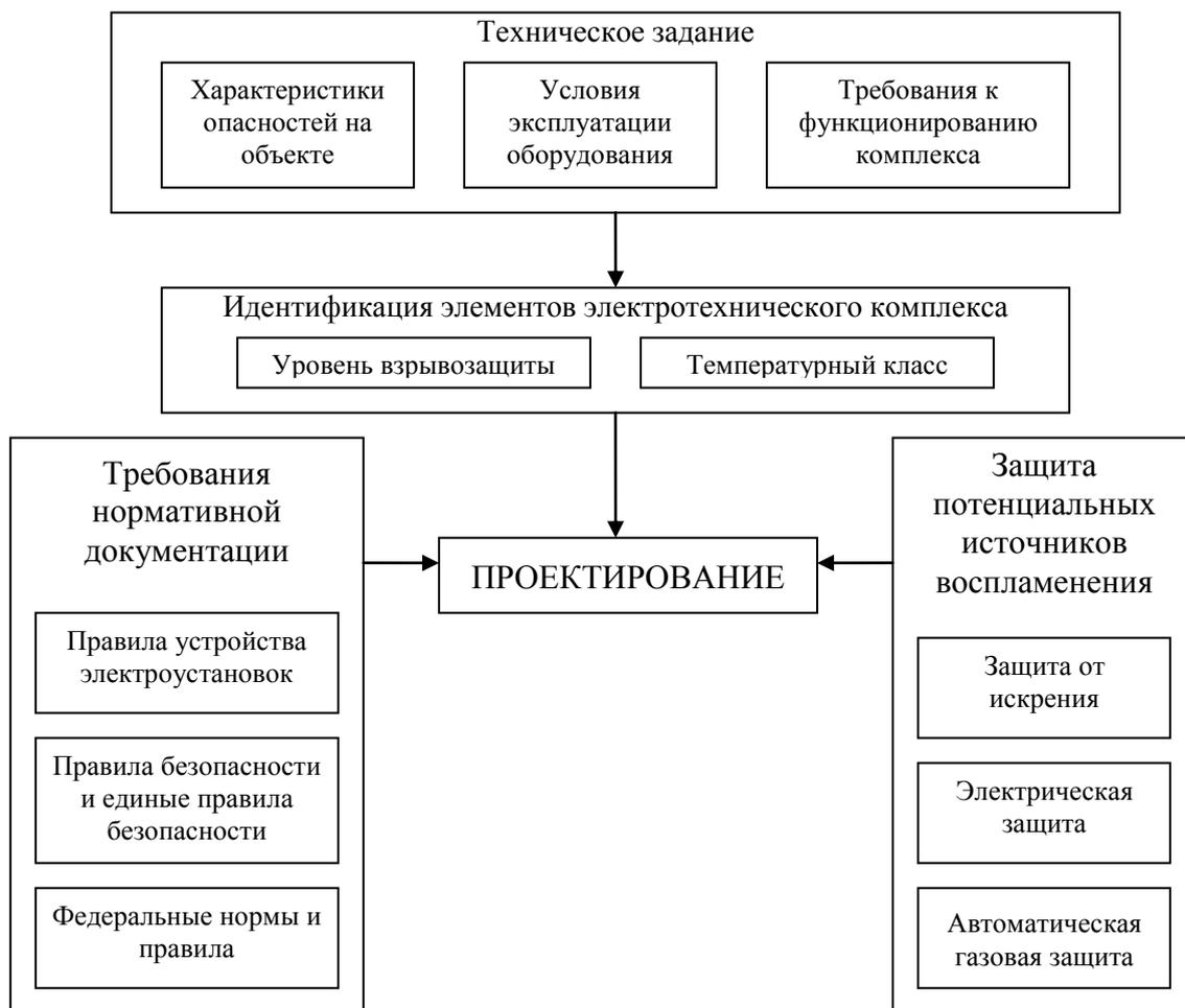
Рисунок 1 – Схема проектирования электротехнических комплексов для взрывоопасных сред
