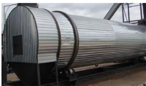
Рис. 1. Сушилка барабанного типа
