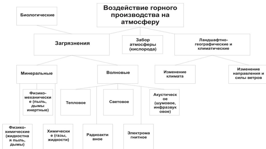
Схема воздействия горного производства на атмосферу
