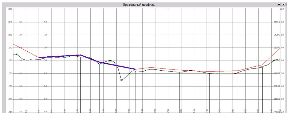
Профиль по ходу полигонометрии с указанием отрезков видимости
