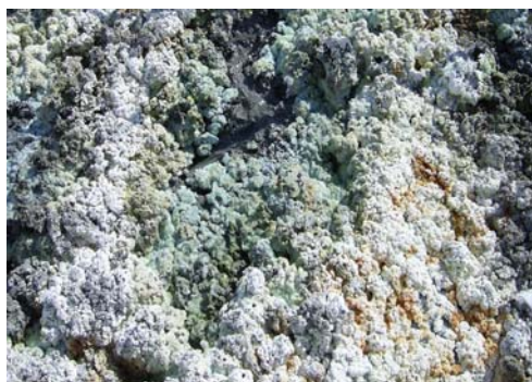
Рис. 2. Образование сульфатов на поверхности штабеля
