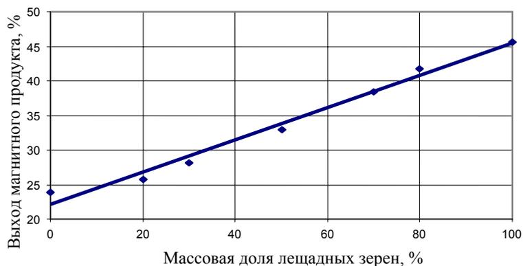
Рис. 2. Зависимость выхода магнитного продукта от массовой доли лещадных зерен в дробленном продукте
