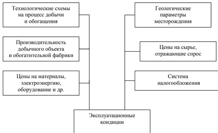
Рис. Система факторов, определяющих размер эксплуатационных кондиций
