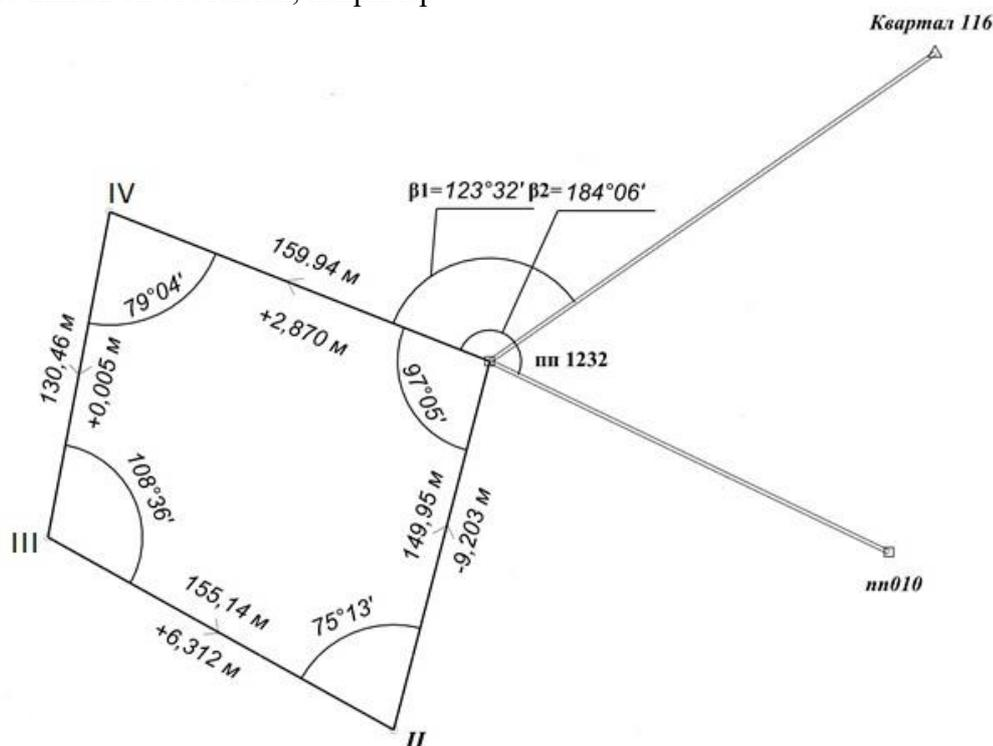
Рисунок 2 – Схема плано-высотного обоснования,.....<sup>1</sup>
