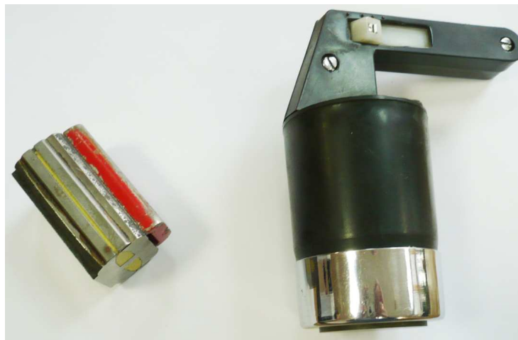
Рис. 2. Малогабаритные лабораторные магниты: постоянный магнит Сочнева (слева) для выделения минералов парамагнитных (электромагнитных) фракций, справа - обычный магнит – «стакан» для отделения ферромагнитных минералов.
