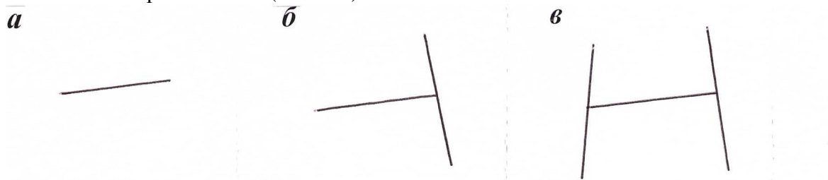
Рис. 1.7. Виды разломов по характеру окончания: а – неограниченные, б – полуограниченные и в – ограниченные
