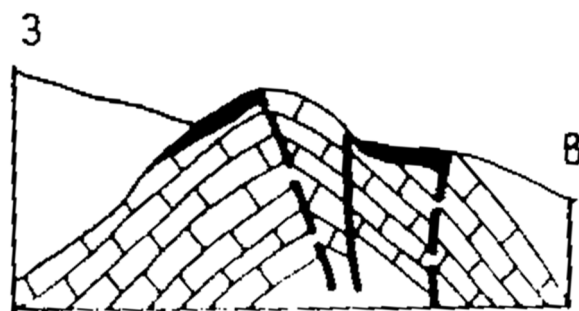
Рис. 1.53. Схематический геологический разрез сурьмяного месторождения Терексай [Атлас]: рудные тела (черное) в сводке антиклинали в известняках
