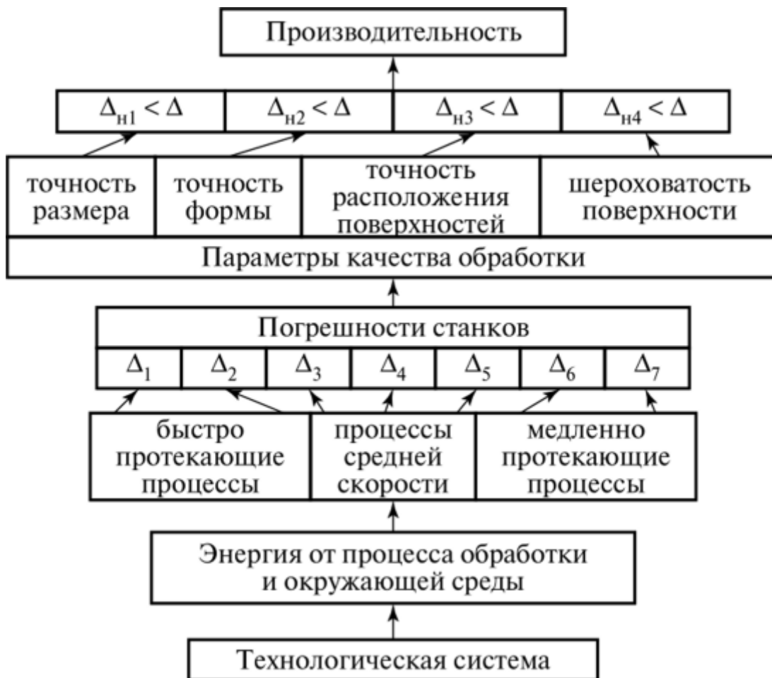
Рис. 2.5. Обобщенная структурная модель формирования показателей надежности и производительности технологического оборудования:
