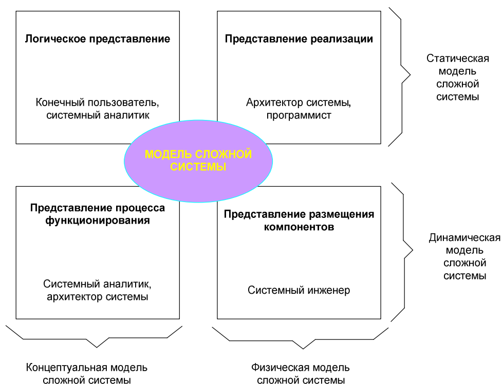
Рисунок 6 – Общая схема взаимосвязей моделей и представлений сложной системы в процессе объектно-ориентированного анализа и проектирования
