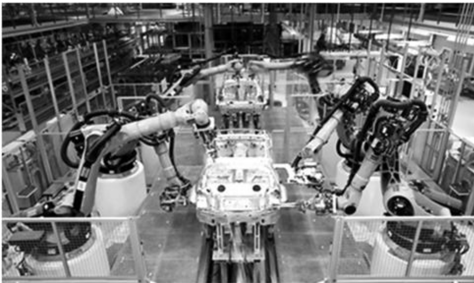
Рис. 1.2. Роботизированная технологическая линия сварки кузова легкового автомобиля
