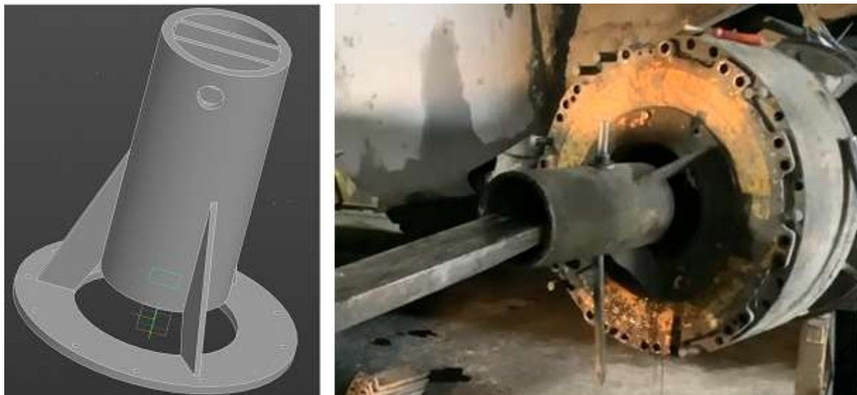
Рис. 1. Съемник водила с сателлитами и способ его применения
