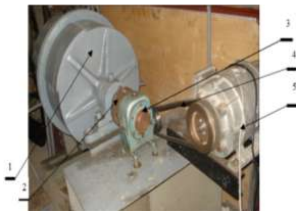
Рис. 2. Опытно-промышленная мельница: 1- корпус мельницы; 2- подшипниковая опора; 3- червячный редуктор; 4- клиноременная передача, 5 – двигатель постоянного тока
