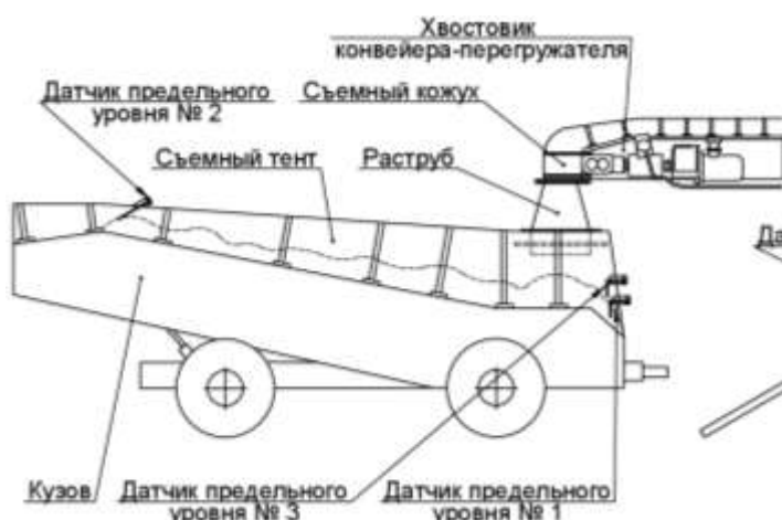
Рис. 4. Общий вид бункера-перегрузчика со съемным тентом
