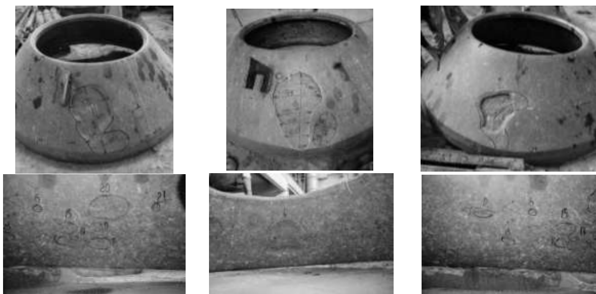
Рис. 3. Износ брони конуса и чаши в процессе эксплуатации
