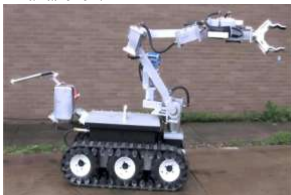
Рис. 1. Робот-спасатель во взрывозащищенном корпусе
