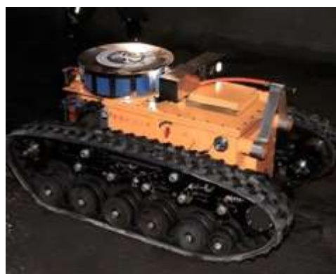
Рис. 1. Робот-спасатель во взрывозащищенном корпусе
