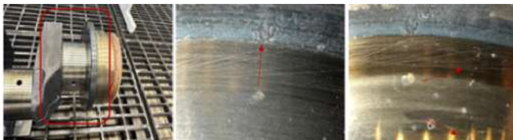
Рис. 3 - Коррозионные язвы на галтелях шейки, абразивный износ шейки
