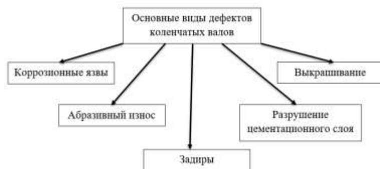
Рис. 2 – Основные дефекты коленчатых валов
