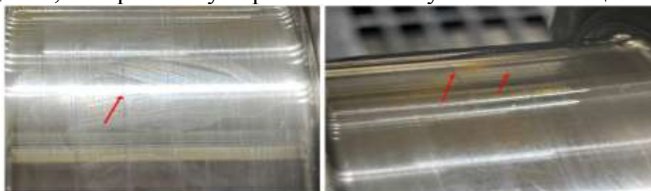
Рис. 5 – Задиры на коренных шейках
