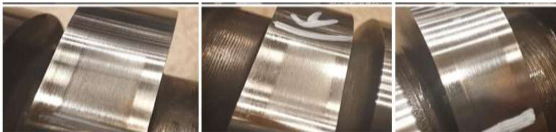
Рис. 4 – Выкрашивание верхнего цементационного слоя на кулачках распределительного вала
