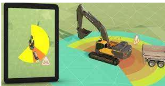
Рис. 3. Схема работы системы предупреждения о препятствиях
