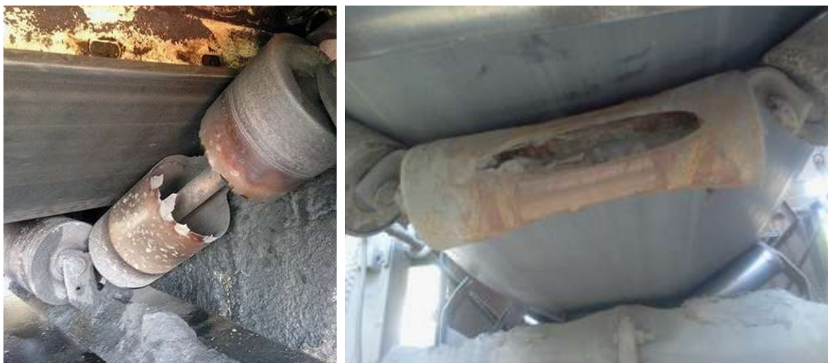
Рис. 1 – Фотофиксация разрушенных корпусов роликов
