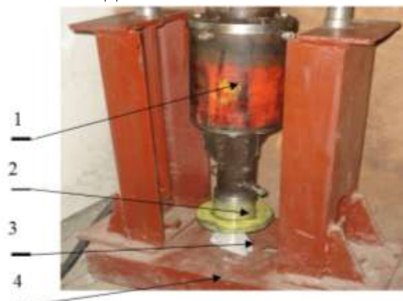
Рис. 1. Магнитно-индукционный импульсный ударный механизм: 1 - корпус ударника; 2- рабочая часть ударника; 3- кусок горной породы; 4 – рама установки
