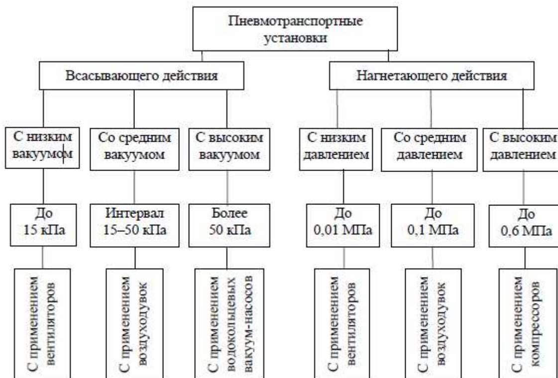
Рис. 2. Схема классификации пневмотранспортных установок по статическому давлению
