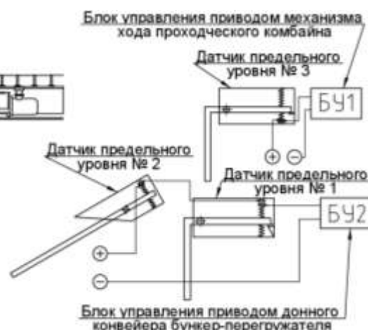
Рис. 5. Схема автоматизации съемного тента
