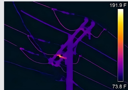
Рис. 5. Изображение ЛЭП, полученное с помощью тепловизора
