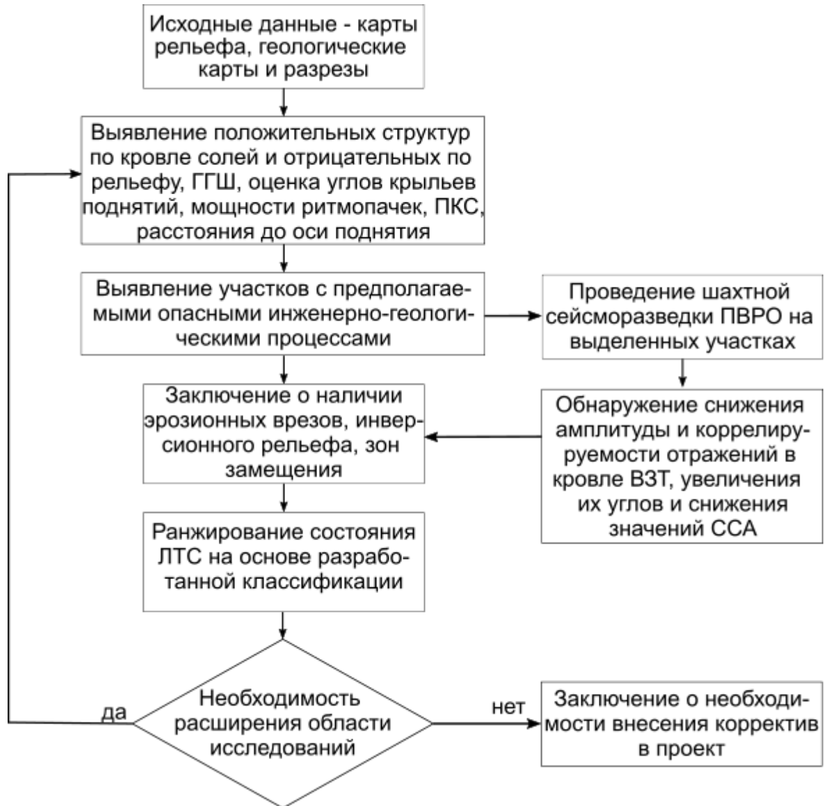
Рисунок 105 – Методика анализа инженерно-геологического состояния и прогноза гидрогеологических свойств водозащитной толщи (по данным автора [214])
