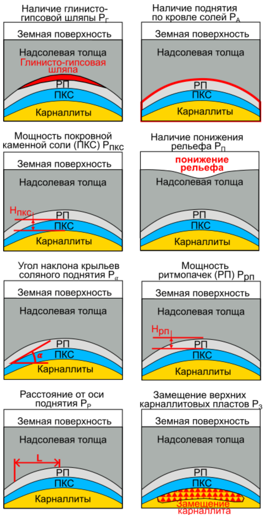
Рисунок 95 – Закономерности структурных характеристик геологического разреза, коррелируемые с риском наличия опасных процессов (по данным автора)
