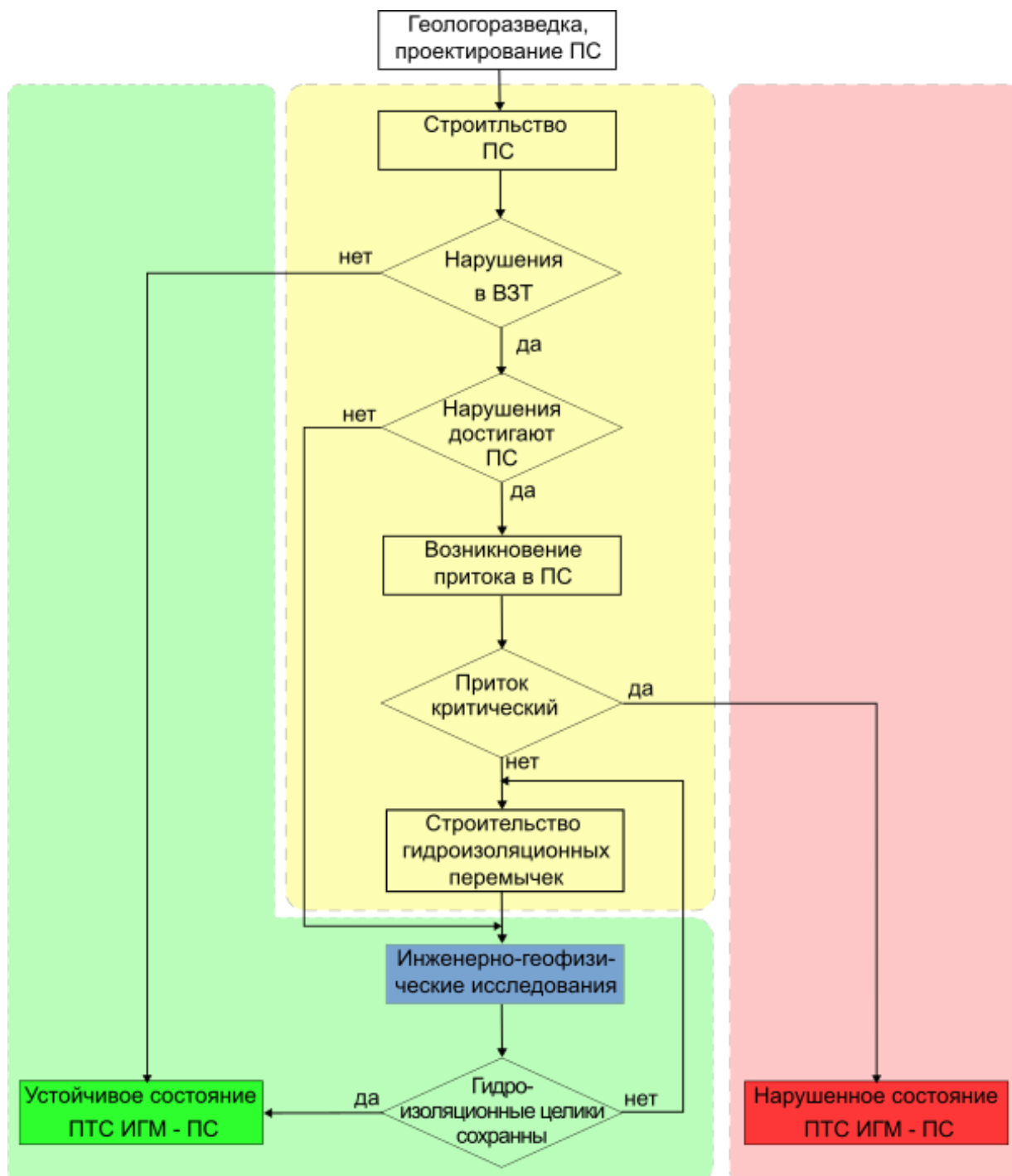
Рисунок 13 – Группа сценариев развития состояния ПТС с контролем ширины и состояния гидроизолирующих целиков (по данным автора)
