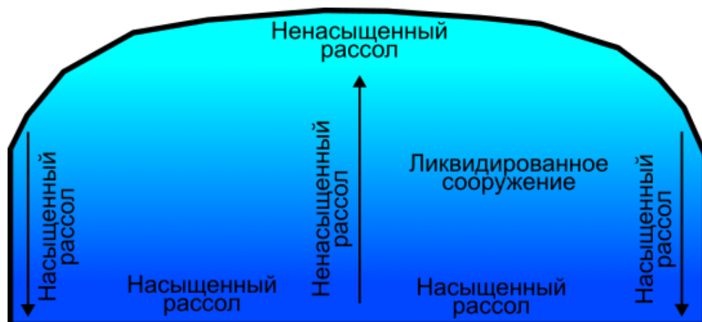
Рисунок 107 – Гравитационная дифференциация рассолов в зависимости от их насыщения – двумерная модель – вертикальный срез вкост оси подземного сооружения, заполненного рассолом (по данным автора)
