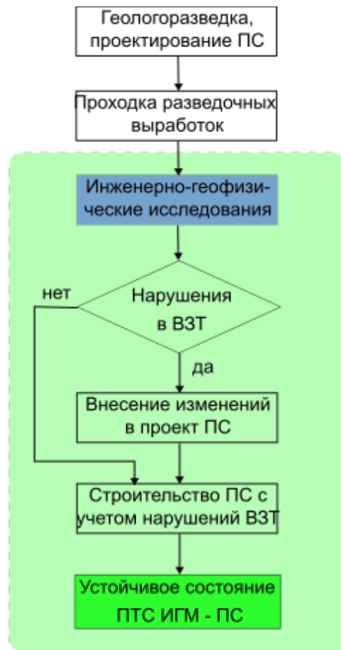
Рисунок 15 – Группа сценариев развития состояния ПТС с контролем ИГУ на стадии проектирования подземных сооружений (по данным автора)]
