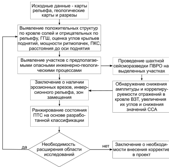
Рисунок 12 – Методика анализа инженерно-геологического состояния и прогноза гидрогеологических свойств водозащитной толщи (по данным автора [36])
