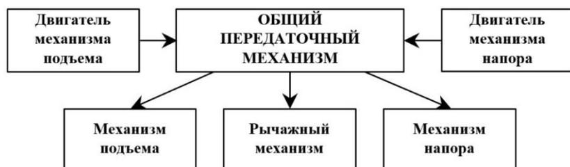
Рисунок 1 – Структурная схема электромеханической системы экскаватора
