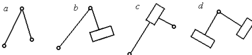
Рис. 1.1. Группы Ассура II класса: a – первого вида; b – второго вида; c – третьего вида; d – четвёртого вида
