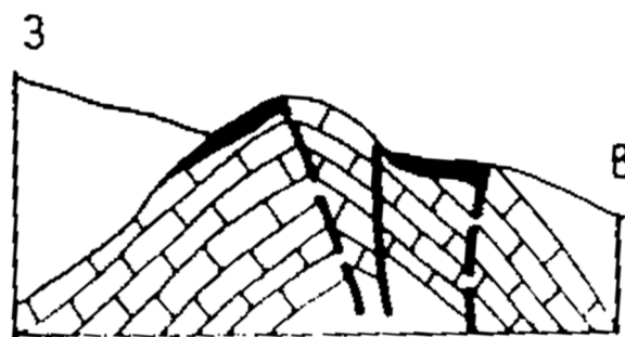
Рис. 1.53. Схематический геологический разрез сурьмяного месторождения Терексай [Атлас]: рудные тела (черное) в свode антиклинали в известняках
