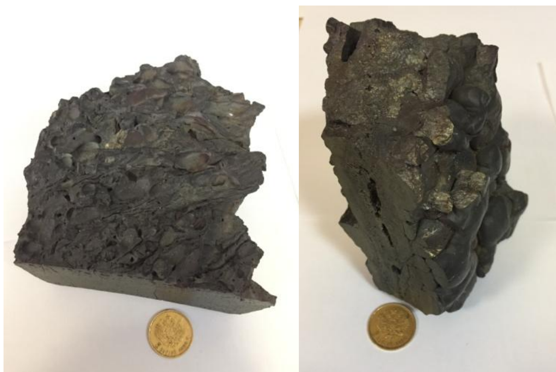
Рис. 3.7. Шлаки Полевского медеплавильного завода
