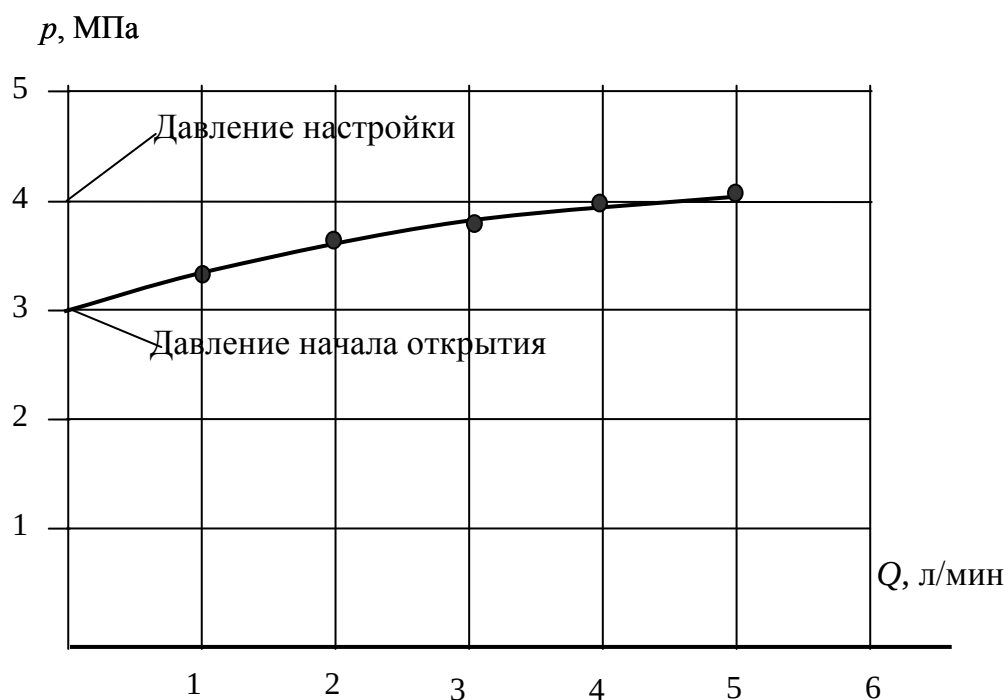
Рис. 1.4. Статическая характеристика настройки клапанов
