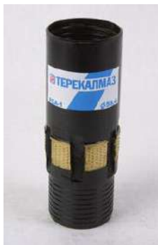
Рис. 2.76. Алмазный расширитель РСА-1.
