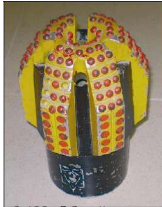
Рис.2.122. Общий вид долота ИСМ секторного типа.
