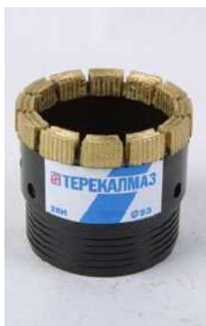
Рис. 2. 40. Импригнированная буровая коронка 28И.
