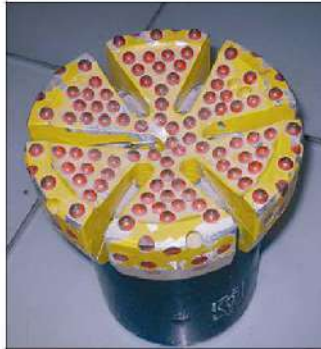
Рис.2.121. Общий вид долота ИСМ торцового типа.
