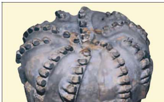
Рис.2. 143. Общий вид долота. Спецификация долота: тип R437GN; размер 8,5"; общая площадь потока 0,6
