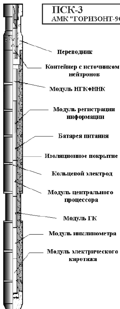
Рис. 1.1. Общий вид скважинного прибора
