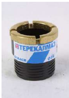
Рис. 2.64. Однослойная буровая коронка 01A4CB.
