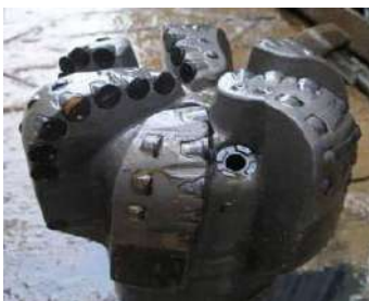
Рис. 1.9. Долото PDC Tornado после проходки 1150 м.
