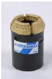
Рис. 2.60. Однослойная буровая коронка K01-2.
