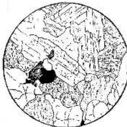
Рис. 9. Гранит. Плагиоклаз, калиевый полевой шпат, кварц и биотит; акцессорный магнетит; диаметр поля зрения 4,3 мм (по А. Н. Заварицкому)
