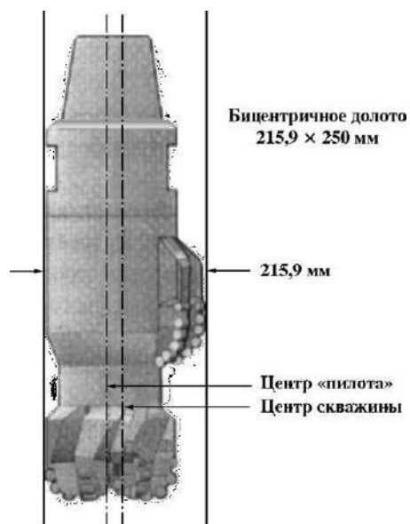
Рис. 2.132. Схема спуска бицентричного долота в скважину
