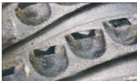
Рис. 2.138. Износ резцов (WT)
