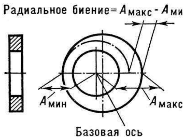
Рис. 7. Схема радиального биения.
