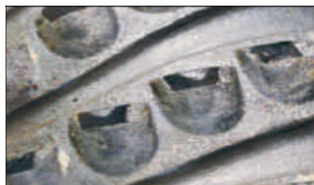
Рис. 2.138. Износ резцов (WT)
