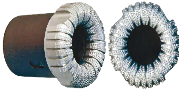
Рис.2.146. Общий вид импрегнированной алмазной бурильной головки
