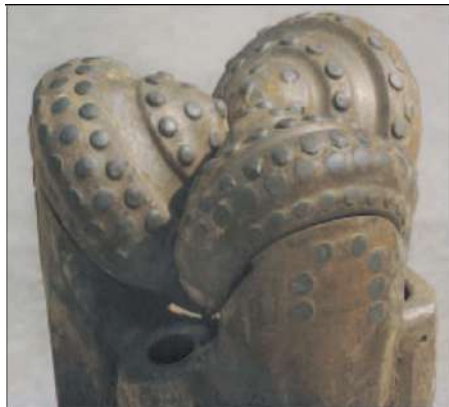
Рис.2.116. Общий вид отработанного долота, описанного в примере 2.
