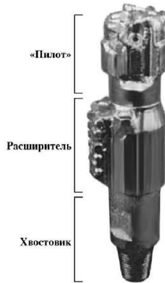
Рис. 2.130. Элементы бицентричного долота
