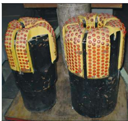
Рис.2.149. Общий вид бурильных головок ИСМ
