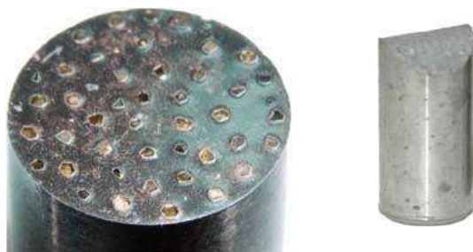
Рис. 1.45. Внешний вид горяче-прессованных вставок ( GHI ).
