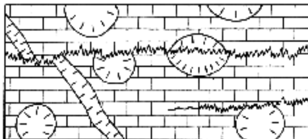
Рис. 16. Стилолитовые швы в известняке, пересекающие стебли кораллов и прожилок кальцита. Верхняя юра, Крым; \frac{1}{2} нат. вел. (по Г. И. Бушинскому)
