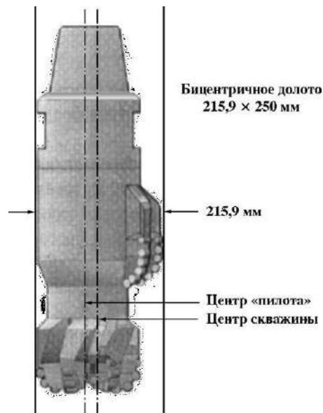
Рис. 2.132. Схема спуска бицентричного долота в скважину
