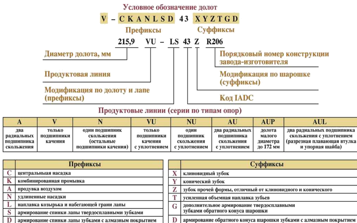
Рис. 2.108. Условные обозначения лицензионных долот производства ОАО «Волгабурмаш».
