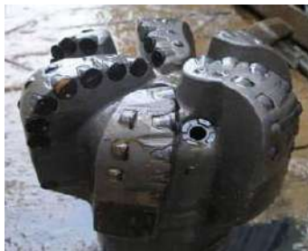
Рис. 1.9. Долото PDC Tornado после проходки 1150 м.
