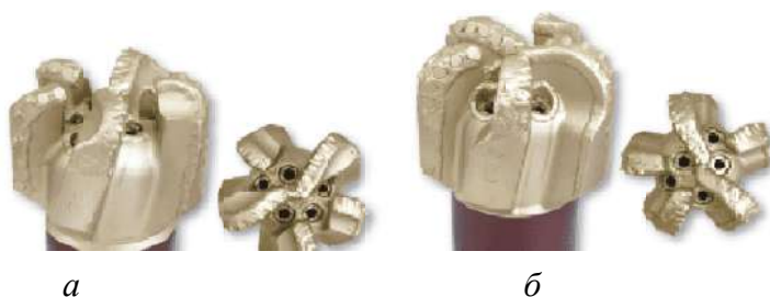
Рис. 1.27. Долота PDC («Волгабурмаш») марки FD – конструктивные особенности – спиральная форма лопастей и установка зубцов PDC на калибрующей части долота: а – долота диаметром 214,3 мм – оснащены резцами обратной проработки; б – долото диаметром 215,9 мм – оснащены антивибрационной защитой долота
