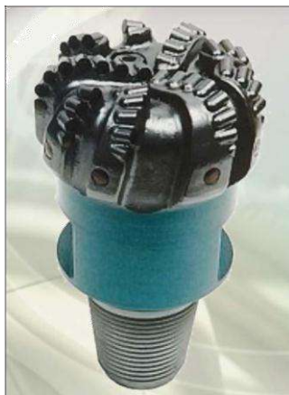
Рис. 2.123. Общий вид долота PDC.
