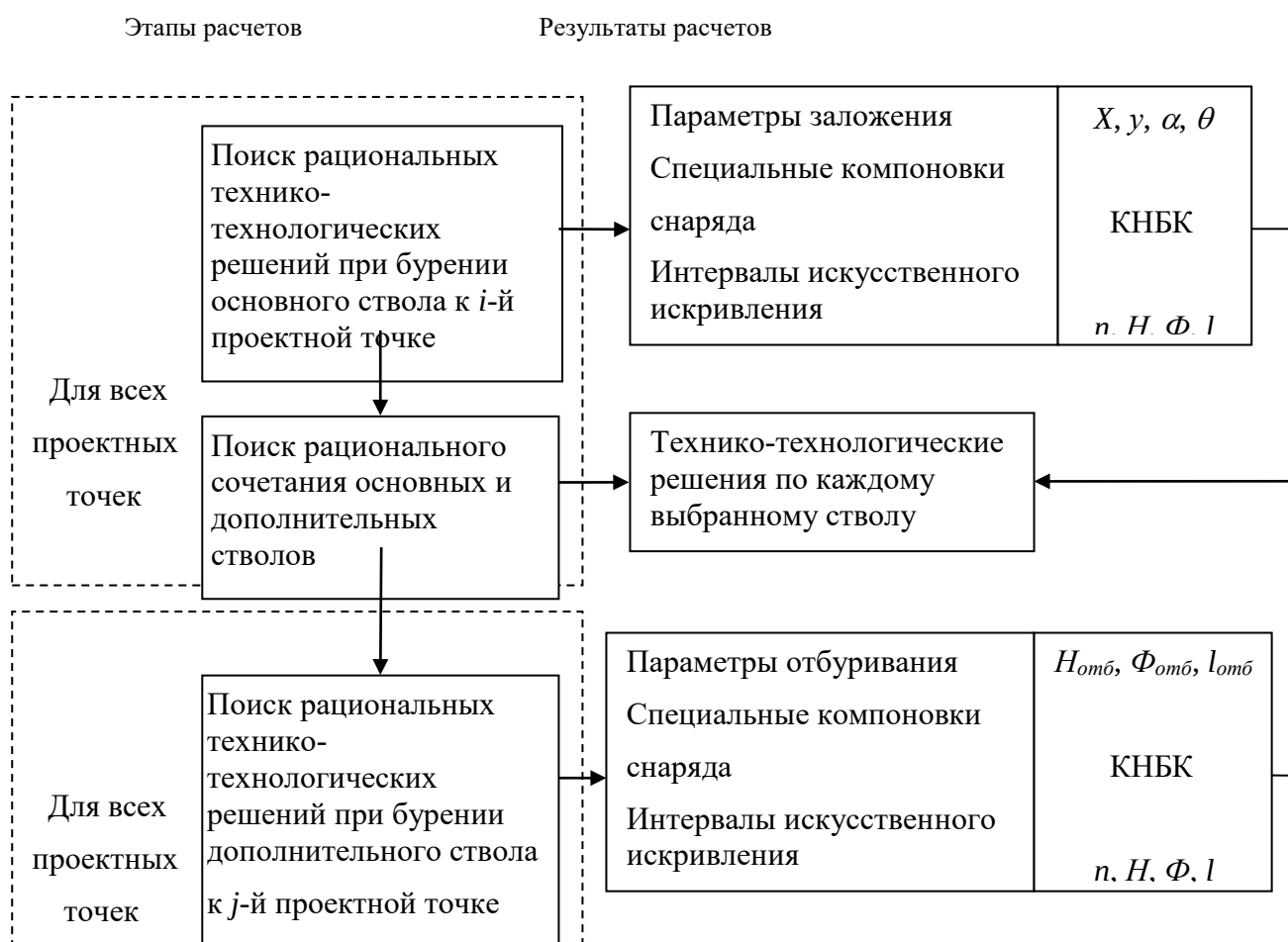
Рис. 1.6. Алгоритм формирования рационального технологического обеспечения при направленном бурении
