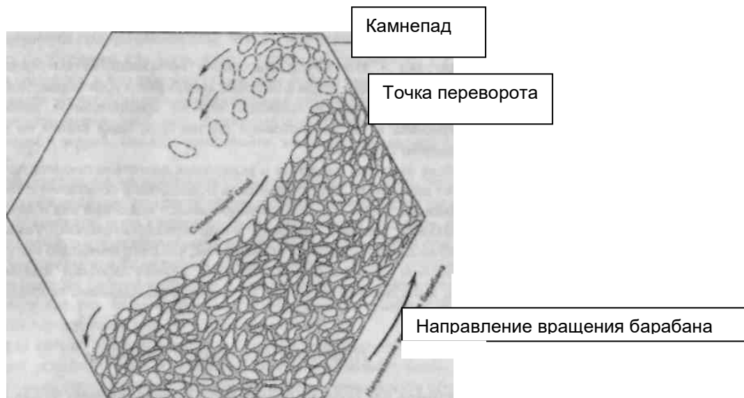
Рис.7. Поведение абразива в галтовочном барабане
